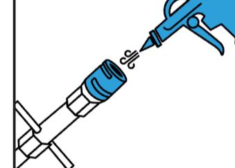
Anschlüsse der Gasrückführung mit Druckluft reinigen.
