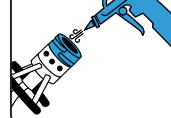
Tankdeckel entfernen & LNG-Tankanschluss mit Druckluft reinigen.
