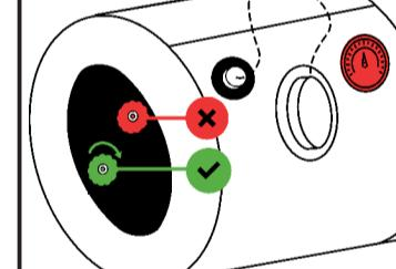
Entlüftungsventil am Tank öffnen. Gas strömt automatisch zurück (Dauer: bis zu 3 Minuten).
