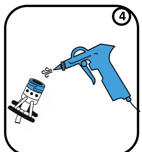
Tankdeckel entfernen & LNG-Tankanschluss mit Druckluft reinigen.
