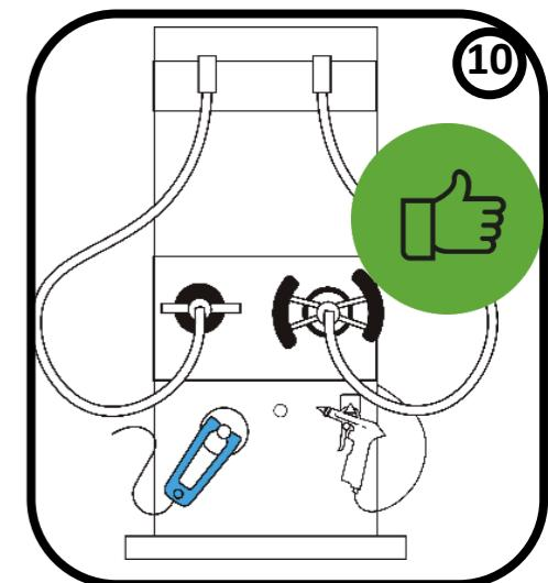
Schließen Sie den Tankdeckel und lösen die Erdungsklemme. Gute Fahrt!
