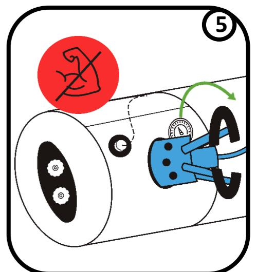
LNG-Kupplung anschließen, gerade aufsetzen & drehen.
